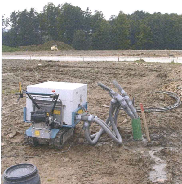
Abbildung A1: Schema eines Geothermal Response Test (GeRT, links) und Durchführung eines Geothermal Response Test mit modernem Gerät von UBeG (rechts)
